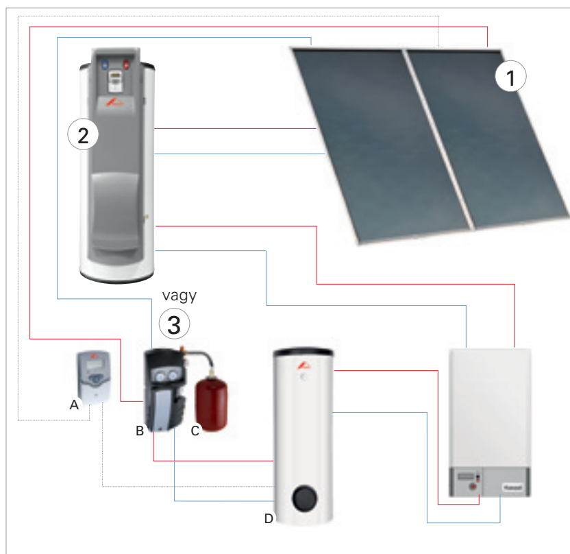
CuboMax és CuboPur rendszercsomag kapcsolási rajz használati víz melegítésére
